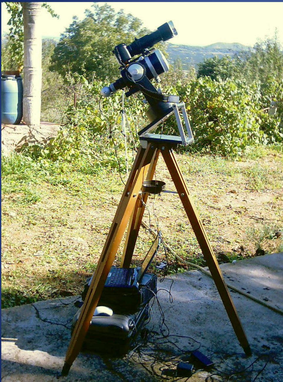
El yayo Alberto llevó un pequeño telescopio con la cámara de fotografiar puesta encima. Los dos llevaban sus filtros para observar el Sol sin dañarse, y con ellos hizo las fotos del eclipse que veréis aquí. Un ordenador controlaba la cámara y disparaba las fotos automáticamente, así el yayo podía ver el eclipse sin preocuparse de la cámara.
